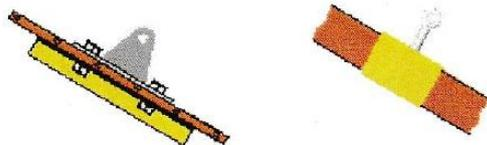
Anker zur Befestigung auf geneigten Dächern, werden unter A2 klassifiziert.
