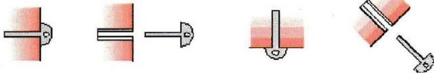
Anker (Klebe, und/oder Dübeltechnik), zur Befestigung an vertikalen, horizontalen und geneigten Flächen, werden unter A1 klassifiziert.
