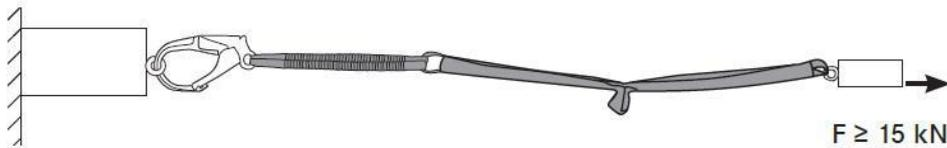
Nach der dynamischen Prüfung muss das System einer statischen Kraft von mindestens 15 kN für 3 min standhalten.
