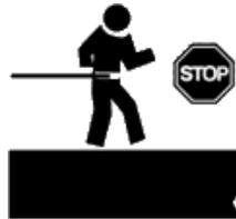
Hierbei gelangt der PSAgA- Anwender lediglich bis zur Absturzkante und wird durch die Verbindung zum Ankerpunkt zurückgehalten.
