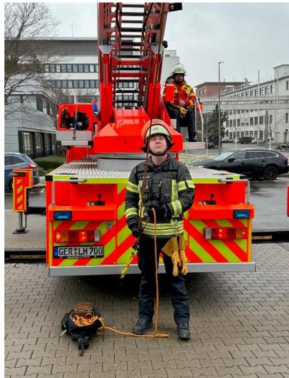
Die Umlenkung am Korb kann an einer vom Hersteller des Fahrzeuges vorgesehenen Öse befestigt werden. Sollte eine solche nicht vorhanden sein, kann ein ausreichend tragfähiges und sauberes Strukturelement genutzt werden.
