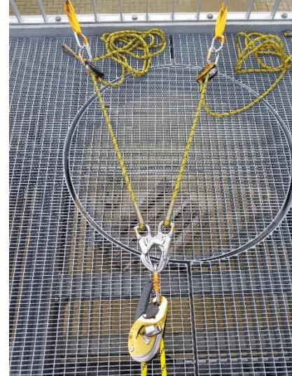
Wichtig ist in beiden Fällen, dass bei der Verwendung von Anschlagmitteln der Grundsatz des Kräftedreiecks beachtet wird!
