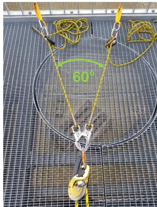
Sollten nur Ankerpunkte vorhanden sein, welche eine recht geringe Tragfähigkeit (z.B. 3 kN) haben, müssen die Kräfte auch hier so aufgeteilt werden, dass die aufgeteilten Kräfte in der Summe, eine Tragfähigkeit von 12kN ergeben.
