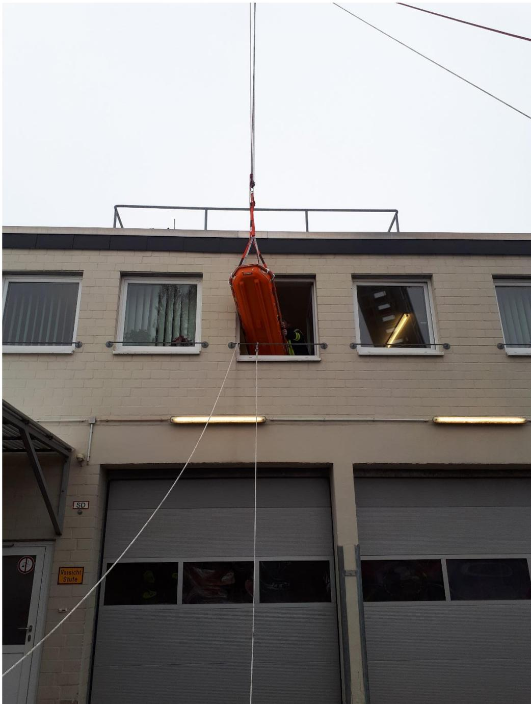
Geübte Drehleitermaschinenisten können die Trage auch gleichzeitig, über verfahren des Leiterparks sanft nach unten verfahren. Durch die entsprechenden Fahrbewegungen kürzt sich das ERHT-Seilsystem automatisch ein.
