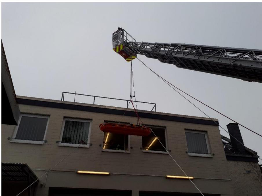
Grundsätzlich wird das Rettungssystem in der ERHT redundant aufgebaut. Dies bedeutet, dass immer zwei identische Systeme parallel aufgebaut werden, welche am Patienten enden.
