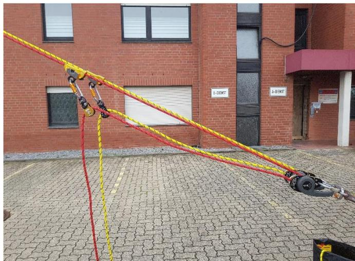
Um eine Person in einer Trage auf-, oder abzuseilen gilt der Grundsatz der Redundanz!
