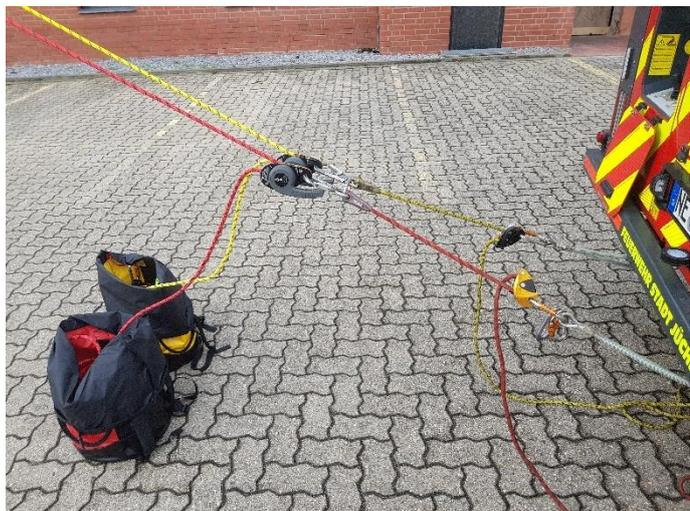
Die beiden Seilbremsen werden so in die Karabiner der längenverstellbaren Verbindungsmittel eingebaut, dass die Bedienhebel nach unten zeigen.
