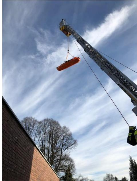
Sollte es nicht möglich sein, am Einsatzort eine Drehleiter in Stellung zu bringen, die Ausstiegsöffnung aber unter 12 Meter liegt, kann auch eine Dreiteilige Schiebleiter verwendet werden.
