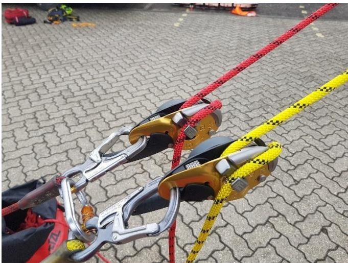
Je nach Hersteller der Bremsgeräte, müssen die Seile beim Ablassen, in zusätzliche Bremsnocken eingelegt werden.
